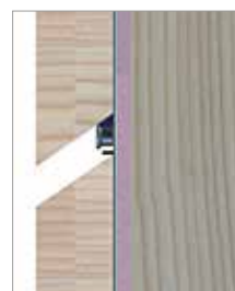
Vzdálenost spáry se automaticky nastaví hlavou profilového vrtu, hotovo!
