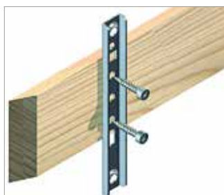
Klip na fasády přiložte zarážkou na zadní straně a zašroubujte profilový vrt.
