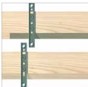
Postup opakujte při osazování veškerých dalších fasádních profilů.
